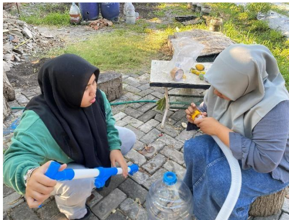
Gambar 2. Proses pembuatan alat penabur pupuk berbahan galon bekas, pipa PVC, dan ban karet bekas.
