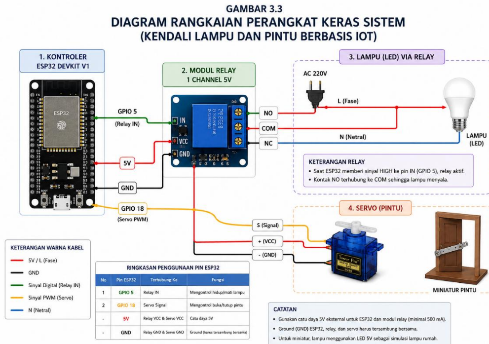
Gambar 2. Diagram rangkaian perangkat keras sistem
