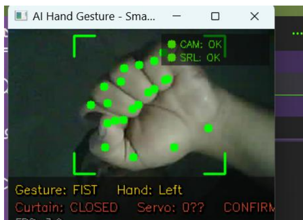
Gambar 4. Pengujian deteksi gesture tutup tirai pada antarmuka program
