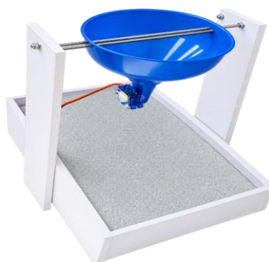
Gambar 2. Implementasi prototipe alat identifikasi jenis pasir
