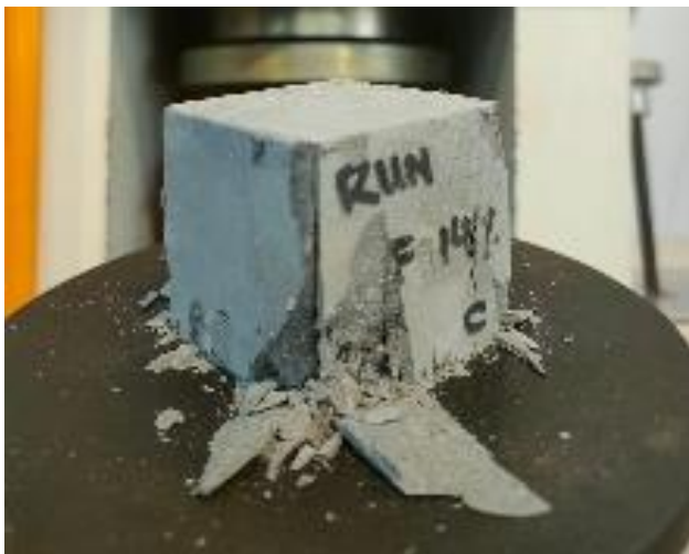
Gambar 9. Retakan banda uji setelah pengujian kuat tekan
