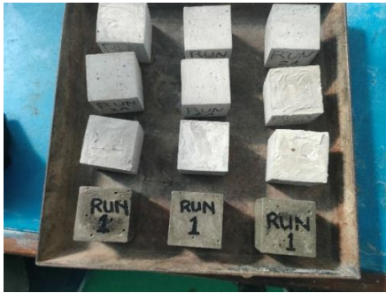
Gambar 6. Benda Uji setelah Proses Perawatan
