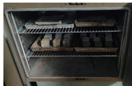
Gambar 5. Proses Sintering Benda Uji Sumber: Hasil Pengujian
