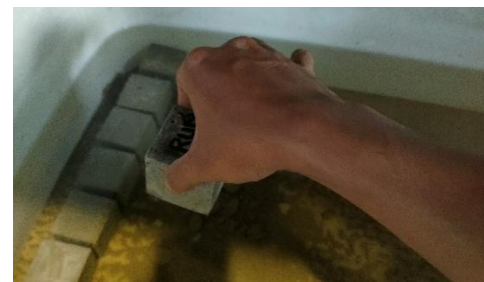
Gambar 4. Proses Curing Benda Uji Sumber: Hasil Pengujian
