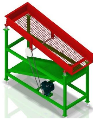
Gambar 3. Desain 3D mesin pengayak
