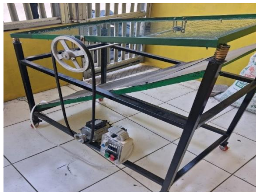
Gambar 4. Mesin pengayak kascing hasil perancangan
